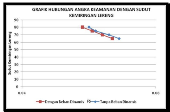
Gambar 5. Grafik hubungan angka keamanan dengan sudut kemiringan lereng kondisi Plastis dari perhitungan metode irisan
