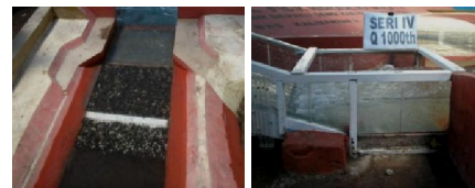
Gambar 6. Perubahan pada seri IV Running model test Seri IV pada stilling basin .
