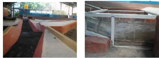
Gambar 8. Perubahan pada seri VI Running model test Seri VI pada stilling basin .
