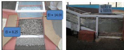
Gambar 7. Perubahan pada seri V Running model test Seri V pada stilling basin .
