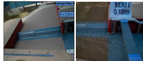
Gambar 3. Perubahan pada seri I dan Running model test Seri I pada spillway.
