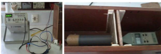
Gambar 1. Skema alat pengukuran Taraf Intensitas Bunyi
