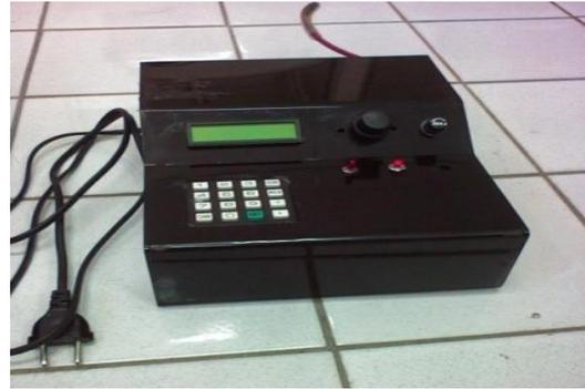
Gambar 1. Pembangkit pulsa tegangan tinggi
