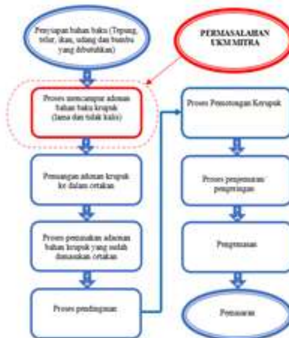
Gambar 2. Bagan alir proses pembuatan kerupuk di UMKM Mitra
