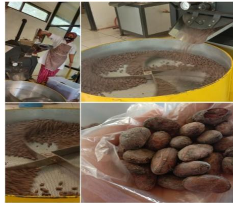
Gambar 2 Proses Penyangraian Biji Kakao Pada Pabrik Pagergunung
