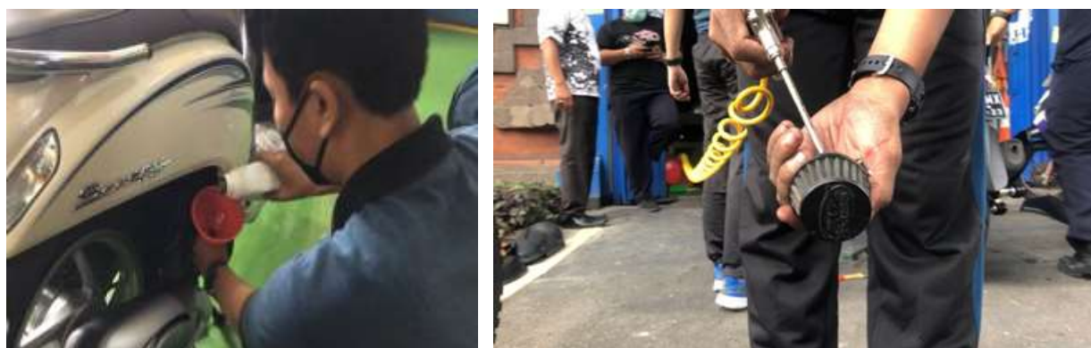
Gambar 2. Pergantian pelumas dan pembersihan filter udara kenaraan pada pelatihan servis berkala
