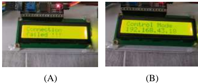
Gambar 9 Tampilan LCD 16×2 (A) Tampilan Ketika Tidak Terhubung (B) Tampilan Terhubung Dengan access point
