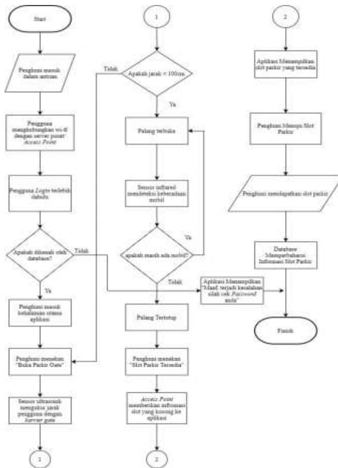
Gambar 8 Diagram Alir Cara Kerja Sistem Keseluruhan
