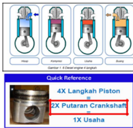
Gambar 5 Prinsip Kerja Engine 4 Langkah
