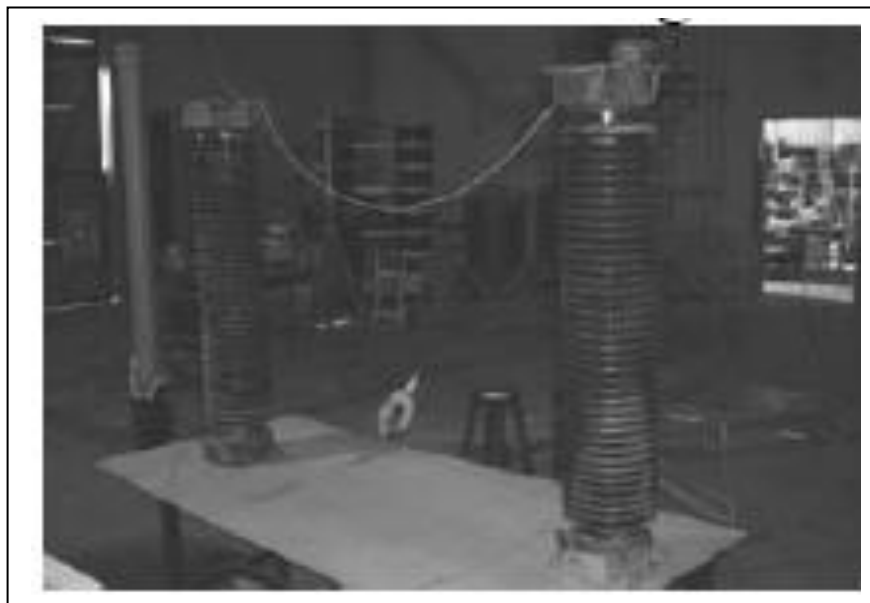
Gambar 1. Arrester dilakukan dengan polusi penggaraman
