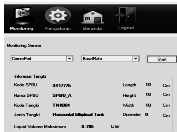
Gambar 20. Tampilan hasil pengaturan model tangki horizontal elliptical
