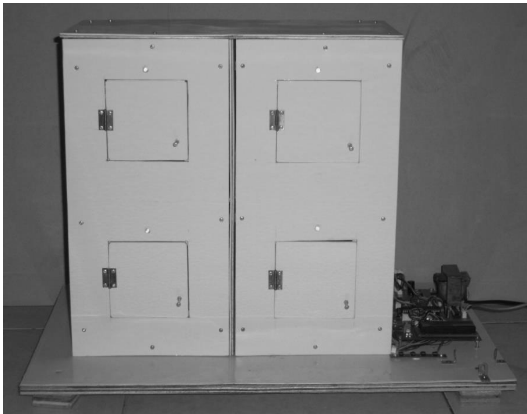
Gambar 11. Foto Locker dengan Pengamanan Kata Kunci Berbasis Mikrokontroler
