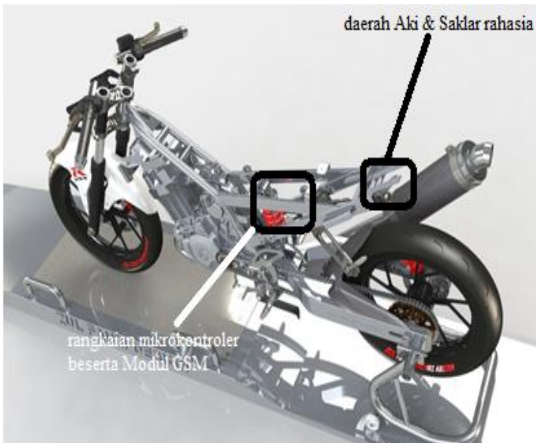
Gambar 3. Perancangan tata letak sistem pengaman sepeda motor [4]
