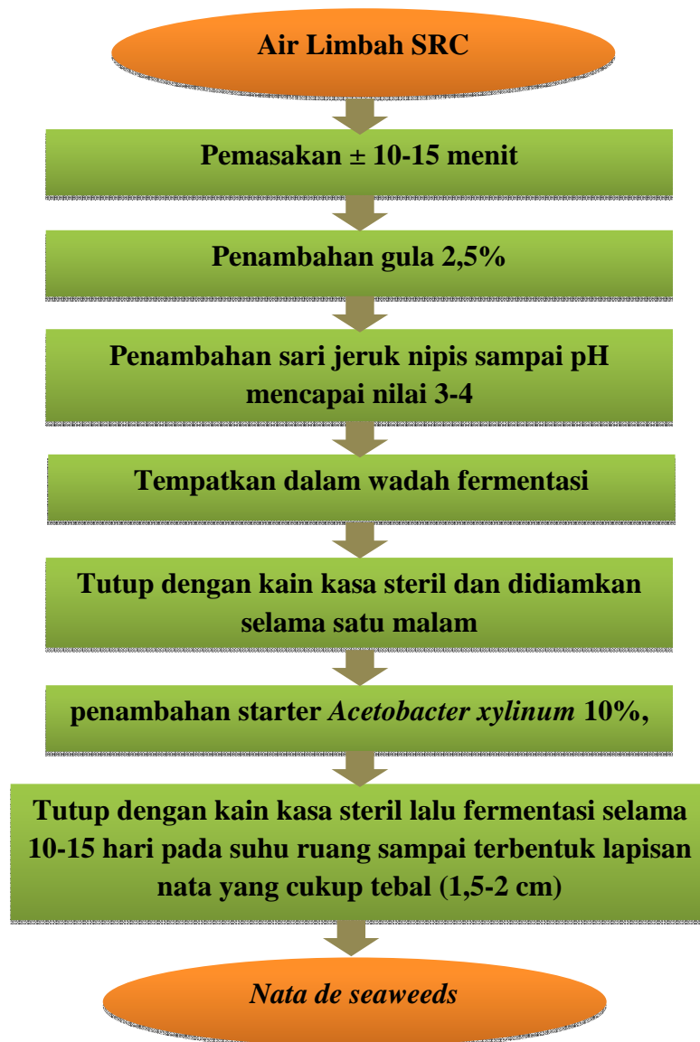
Gambar 2 Diagram alir dari proses pembuatan nata de seaweeds dari air limbah SRC
