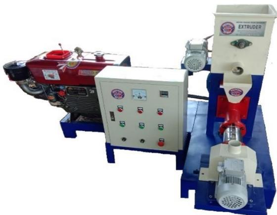
Gambar 2. Desain alat Extruder yang digunakan untuk membuat pakan lele
