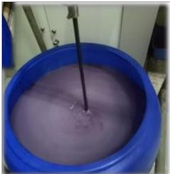
Gambar 2. Proses pengadukan adsorben eceng gondok
