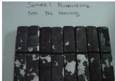
Gambar 2. Bercak putih merupakan lempengan kecil aluminium yang melekat setelah sampel di hot dip aluminizing (Ammar, 2014).
