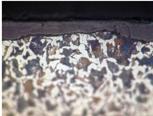
Gambar 13. Struktur mikro sampel baja S45C setelah aluminizing dengan pembesaran 1000x
