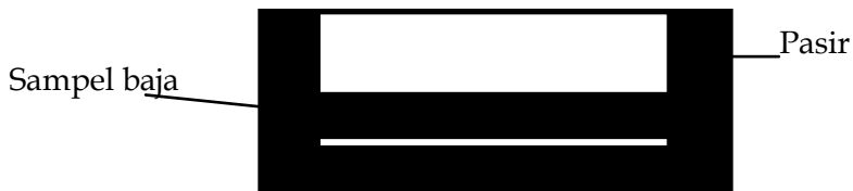
Gambar 5. Persiapan cetakan untuk simulasi die casting
