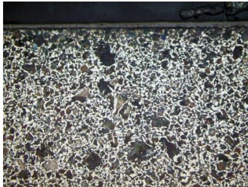
Gambar 11. Struktur mikro sampel baja S45C setelah aluminizing dengan pembesaran 200x
