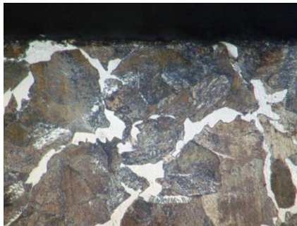
Gambar 10. Struktur mikro sampel baja S45C awal dengan pembesaran 1000x Terlihat dari Gambar 10 sampel baja S45C pada bagian permukaan tidak terlihat lapisan inter metalik dengan struktur mikro ferrit dan pearlit.
