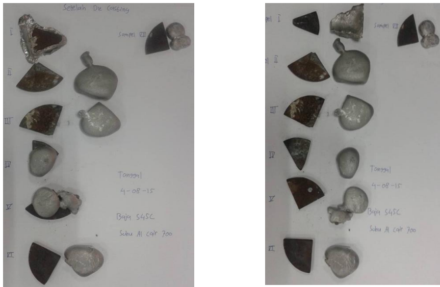
Gambar 7. Hasil simulasi die casting sesaat setelah penuangan aluminium cair (a). Pelepasan aluminium yang melekat pada sampel baja yang telah dialuminizing (b).
