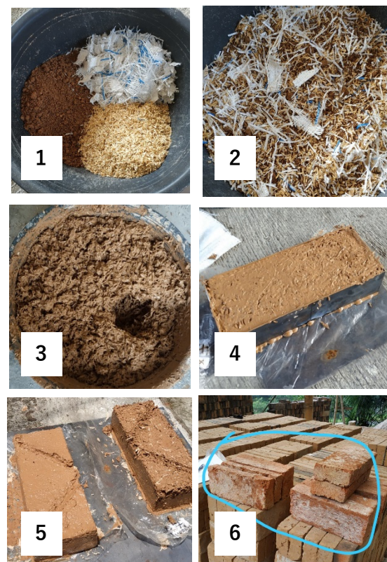
Gambar 4. Proses pembuatan batu bata Sumber: dokumen penulis, 2020
