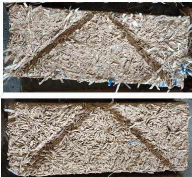
Gambar 5. Komposisi dengan 60% plastik (atas) dan komposisi dengan 60% sekam padi (bawah)
