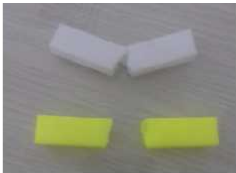
Gambar 3.8. Contoh Hasil Uji Pukul Charpy A3-1
