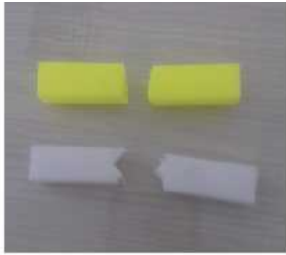
Gambar 3.7. Contoh Hasil Uji Pukul Charpy A2-1
