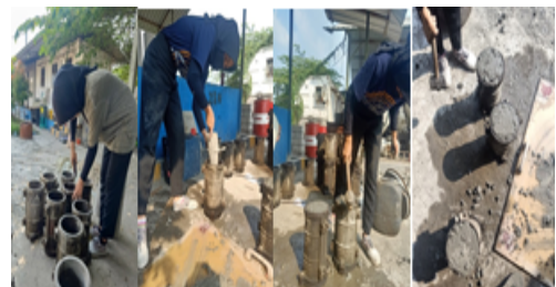
Gambar 2.4 Proses pembuatan benda uji beton umur 24 jam
