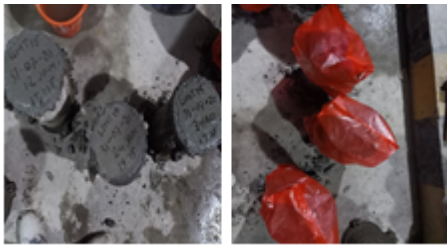
Gambar 2.5 Proses perawatan benda uji beton umur 24 jam
