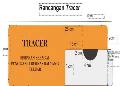
Gambar 1.4 Draft Rancangan Tracer Alternatif II berbahan Kertas
