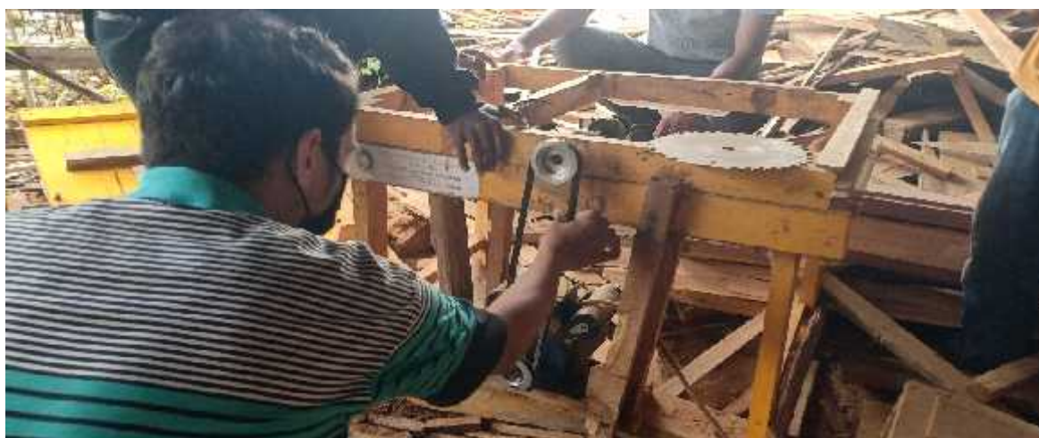
Gambar 2. Uji Stel Belt dari Motor Listrik ke Gigi Gergaji Pembelah
