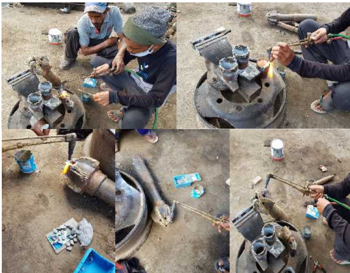
Gambar 8. Pemasangan Cutter pada Matabor
