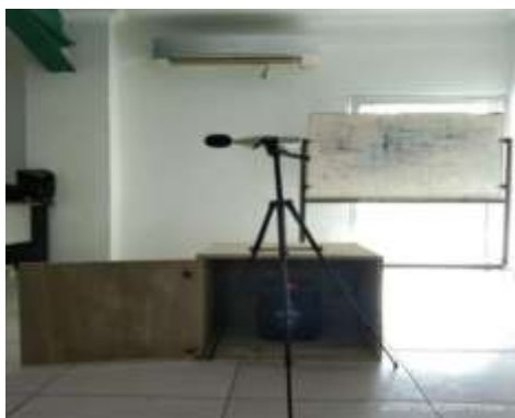
Gambar 2. Pengukuran tingkat kebisingan tanpa media peredam tanaman
