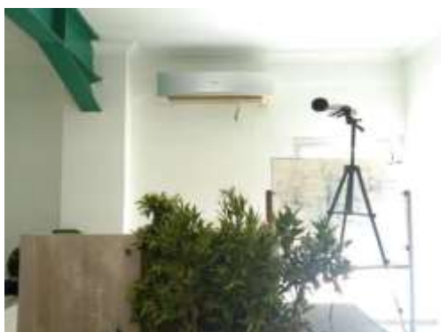
Gambar 3. Pengukuran tingkat kebisingan menggunakan media peredam tanaman pucuk merah
