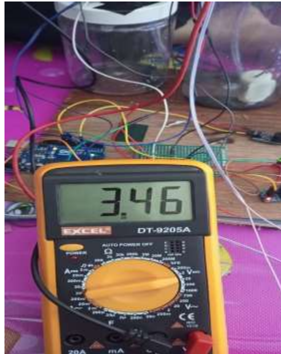
Gambar 13. Pengukuran Tegangan Sensor Ultrasonik.
