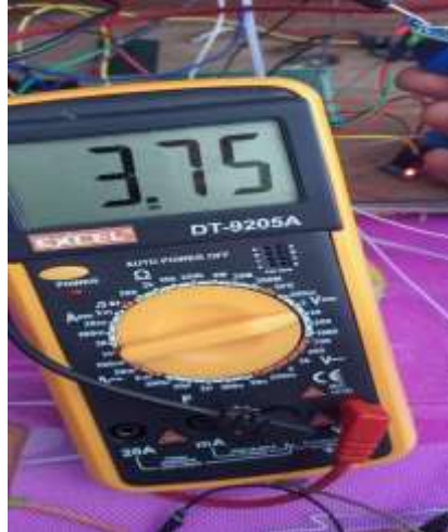
Gambar 11 Pengukuran tegangan Relay
