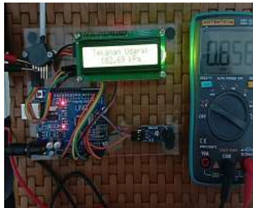
Gambar 11. Pengujian Sensor MPX5700AP Dalam Satuan kPa
