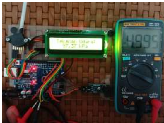
Gambar 14. Pengujian LCD Saat Tidak Ada Tekanan Udara
