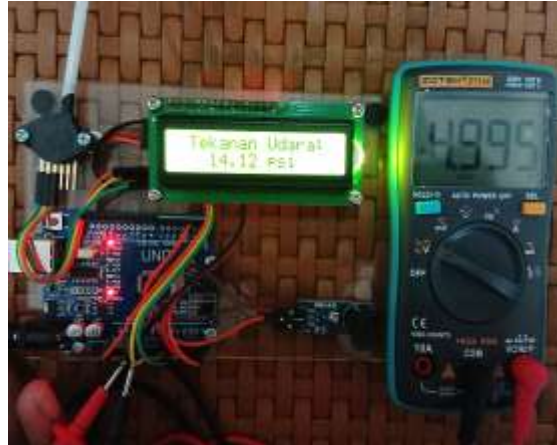
Gambar 15. Pengujian LCD Saat Ada Tekanan Udara Satuan psi
