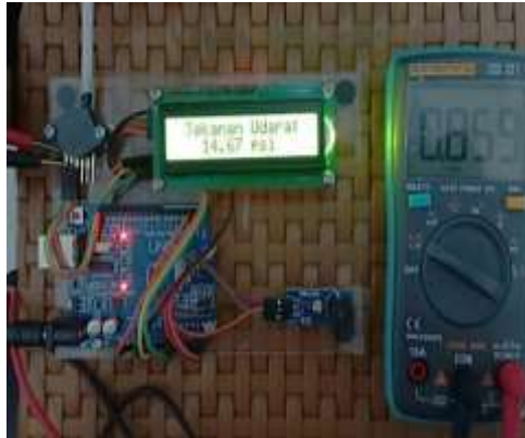
Gambar 10. Pengujian Sensor MPX5700AP Dalam Satuan psi
