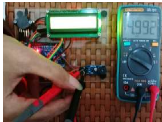
Gambar 16. Pengujian LCD Saat Ada Tekanan Udara Satuan kPa
