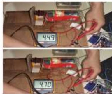
Gambar 13. Hasil Pengukuran Tegangan Pompa Air
