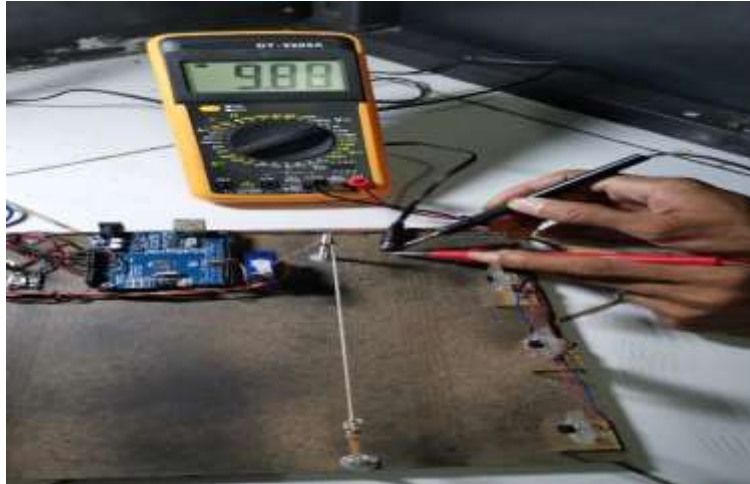
Gambar 4.4 Hasil pengukuran tegangan Catu Daya
