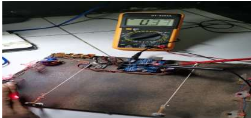
Gambar 4.6 Hasil pengukuran tegangan motor servo saat aktif
