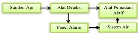
Gambar 10. Skema sistem deteksi alarm otomatis
