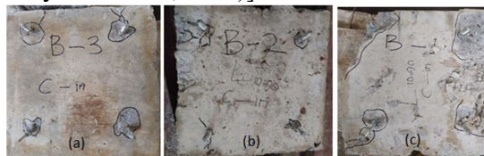
Gambar 3. Mode kegagalan pada sampel cast-in place
