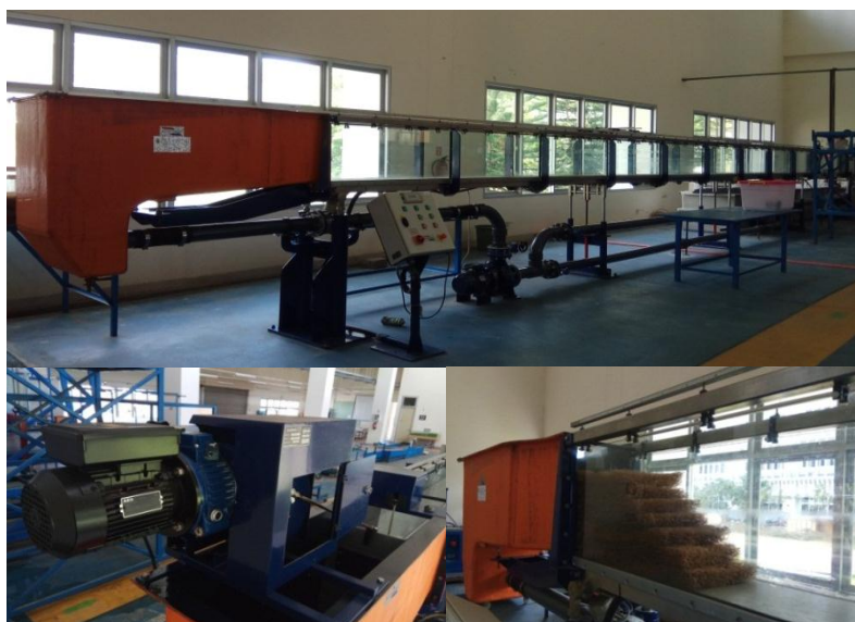
Gambar 1. Tangki, peredam dan mesin pembangkit gelombang tipe flap ( Wave flume )
