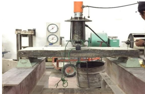
Gambar 5. Pengujian kuat lentur
