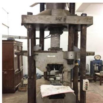
Gambar 4. Pengujian kuat tekan dengan UTM
