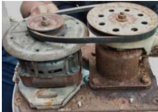
Gambar 2. Letak Puli dan Sabuk-V mesin cuci Samsung diamond drum WA80V4.
