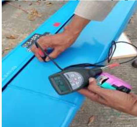
Gambar 15 Proses Pengecekan Ketebalan Cat
