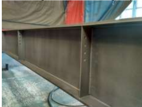
Gambar 14 Material yang Telah di Sandblating
