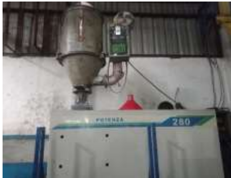
Gambar 2. Mesin Injeksi Plastik
