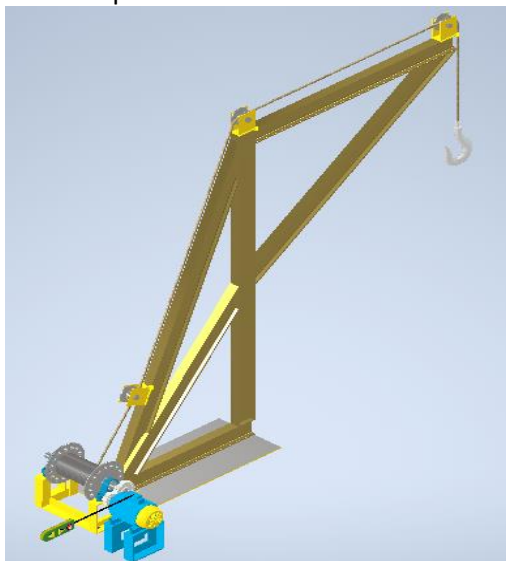
Gambar 1. Desain alat angkat jaring ikan
