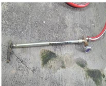
Gambar 3. Cutting Torch setelah pemasangan
