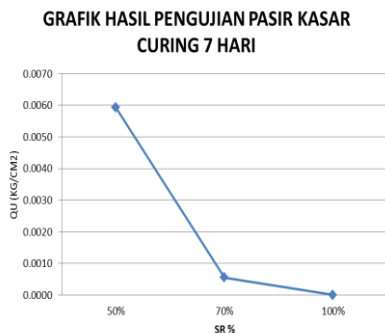
Gambar 8 Grafik Pengujian Gabungan Unconfined Compressive Strength Test Pada Umur 7 Hari dengan variasi derajat kejenuhan 50%, 70%, 100%.
