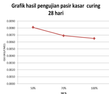
Gambar 9 Grafik Pengujian Gabungan Unconfined Compressive Strength Test Pada Umur 28 Hari dengan variasi derajat kejenuhan 50%, 70%, 100%.
