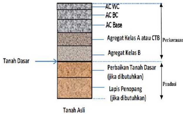
Gambar 2. Struktur Perkerasan Lentur pada Permukaan Tanah Asli (Ditjen. Bina Marga, 2012,)
