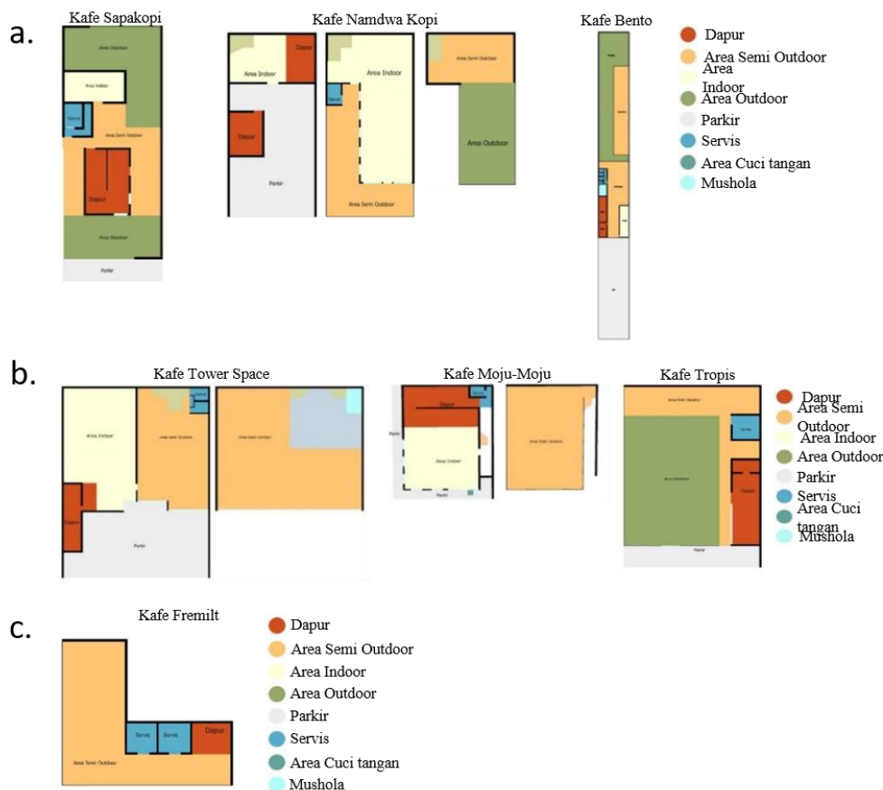
Gambar 1. (a) Bentuk denah dan Tata letak Kafe Tipologi A (Memiliki 3 Area: Indoor, Semi Outdoor, dan Outdoor, (b) Denah Kafe Tipologi B (Memiliki 2 Area), (c) Denah Kafe Tipologi C (Memiliki 1 Area)
