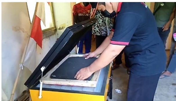
Gambar 5. Proses Penyinaran (Afdruk) Gambar
