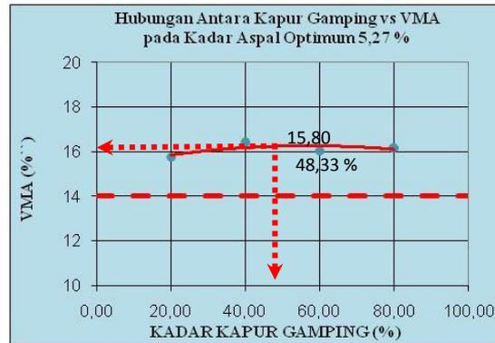
**Gambar 8.** Hubungan antara kapur gamping terhadap rongga diantara agregat
