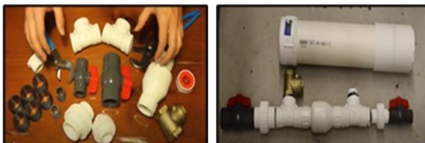
**Gambar 3:** Bahan & bentuk sederhana pompa hidram
