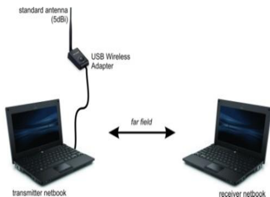
Gambar 3.5 Pengujian gain dengan antenna referensi
