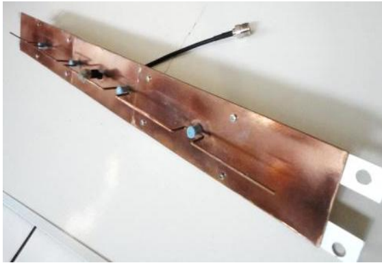
Gambar 4.11 Sectoral antenna yang telah selesai dibangun
