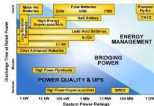
Gambar 7. Perbandingan Power Rating dan Discharge Duration antar teknologi yang umum digunakan (San Martin et al, 2011)
