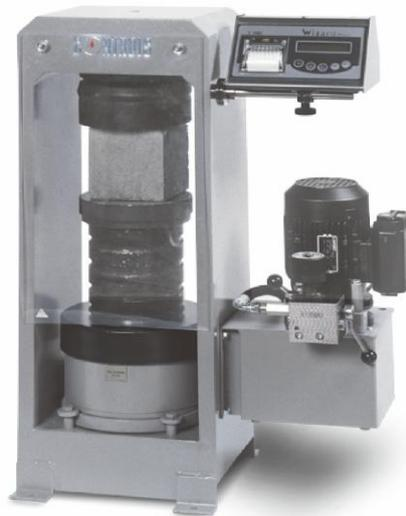
**Gambar 4.** Alat Uji Kuat Tekan Beton
