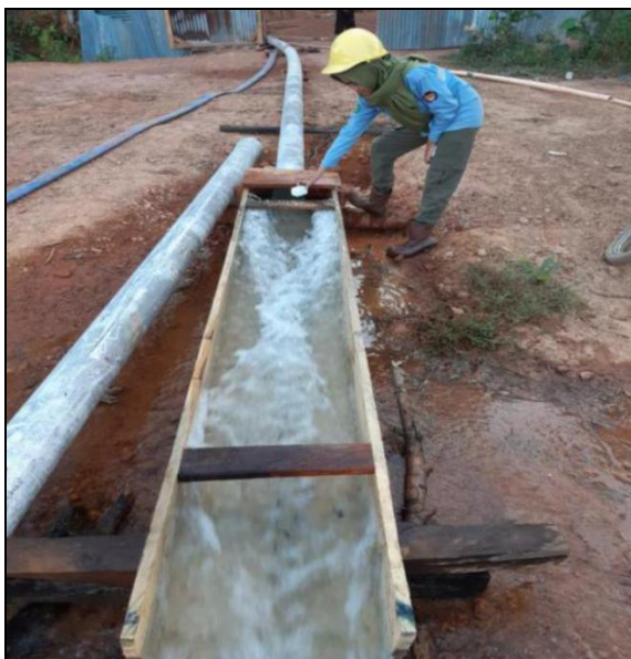
Gambar 5. Pengukuran debit aktual secara manual
