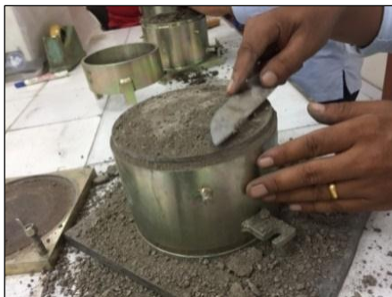
Gambar 6. Hasil proses pemadatan metode kompaksi Modified Proctor
