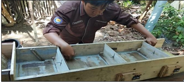
Gambar 5. Kegiatan pencucian bijih timah dengan Underflow Sluice Box
