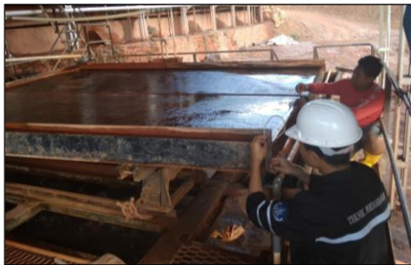
Gambar 4. Pengukuran kemiringan meja
